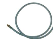
**Hochdruckschlauch** mit NW 4 mm, beidseitig mit Messinganschluss, G 1/8", metallgewebeummantelt zum Schutz vor heißen Spänen im Arbeitsraum
